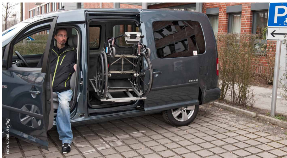
Bei dem Van lassen sich auf Knopfdruck die Türen öffnen und der Rollstuhl abladen
