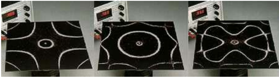
Abbildung 1.7: Chladnische Klangfigur mit quadratischer Platte (Uni Kalifornien, San Diego)
