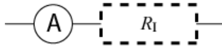
Abbildung 8: Der Innenwiderstand des Messgerätes wird zur besseren Veranschaulichung manchmal in das Schaltbild eingezeichnet.
