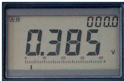
Abbildung 9: Digitalmessgerät: die gemessenen Größen werden in diskreten Werten, d.h. als Zahlen, angezeigt; Quelle: Conrad Electronic SE
