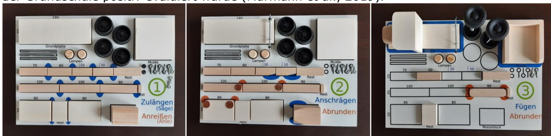
Abb. 1: Stationen 1 – 3 von links nach rechts als methodische Reihe zum Bau des Lasters im Maßstab 1:1 inklusive maßstabsgetreuer Abstände der Schnitte
